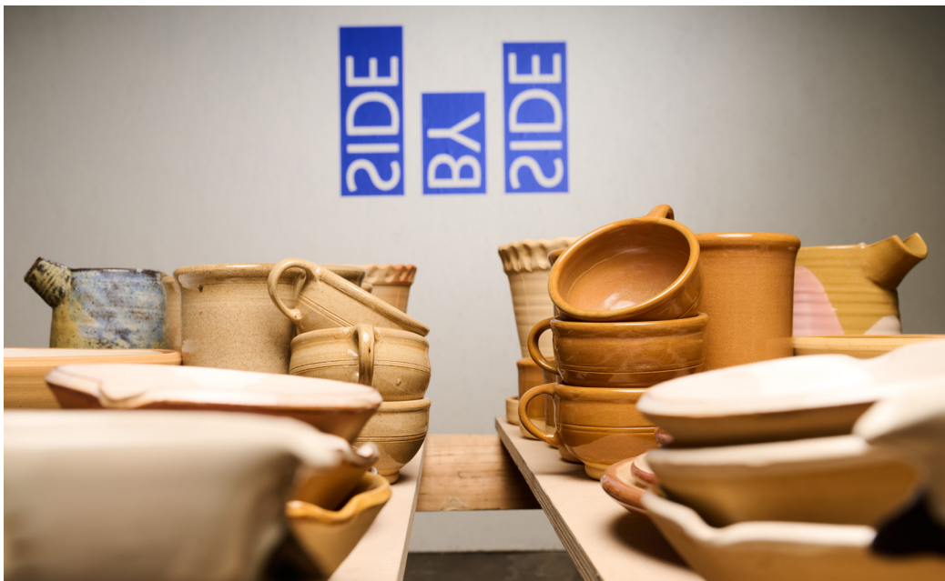
Fig. 1 Testproduktion- erne af lertøj og stentøj. Identiske emner: Antal, vægt og formgivning er det samme for de to produktioner.
